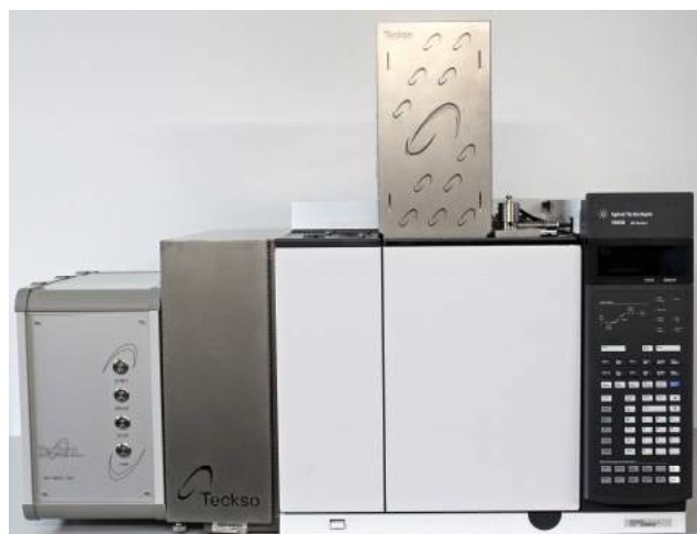
Agilent 7890 GC mit Teckso Ventilofen, Spurverbreiterung und MultiTec Controller
